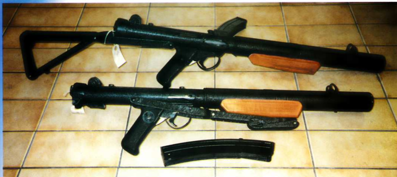
1. ja 2. Kaksi 9x19mm Patchett/Sterling MARK 5 konepistoolia. Olkatuki taittuu aseeseen alle. Hieman kaarevaan tankolippaaseen mahtuu 34 patruunaa.
