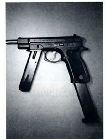
■ Konepistooliin on kiinnitetty vaihtolipas etukahvaksi. Tämä on yksi tämän asemallin innovaatioita.
