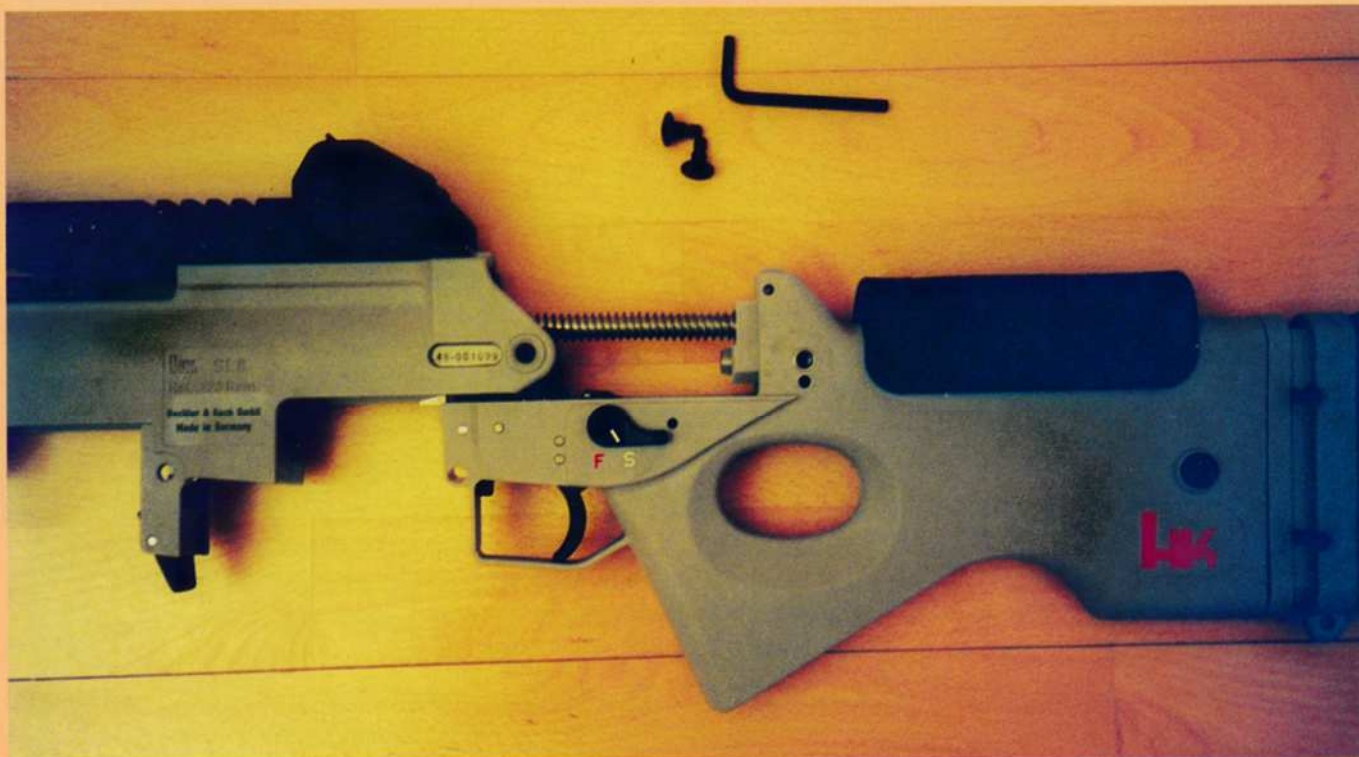
■ Olkatuki, laukaisukoneistoinen vedetään asean rungosta irti, palautin jousi seuraa mukana.
