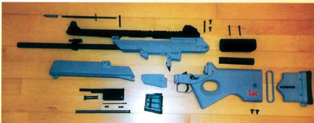
■ SL8 osapurettuna huoltoa ja säätöä varten.
