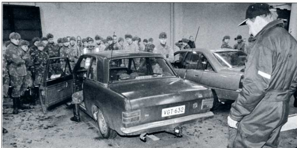
■ Katsastaja Paavo Kekäläisen tarkka silmä havaitsee Olli Saukkosen Ford Cortinasta, että rekisterikilven päällä olevasta lampusta puuttuu suojakupu.
