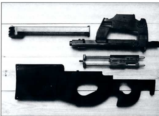
■ P90 konepistooli osittain huoltopurettuna. Pääosat; alarunko, ylärunko, lukkolaite ja lipas. Alarungosta voidaan irrottaa vielä laukaisukoneisto perälevyä irrottamalla. (Kuva FN Herstal)
