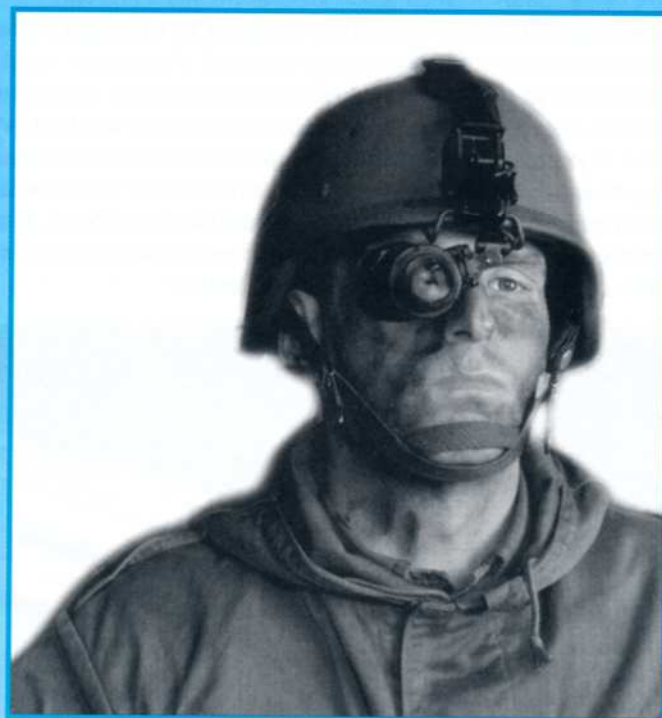
■ Jalkaväelle sopivaa valonvahvistinta aletaan jakaa joukoillemme vuoden 1998 aikana. Kuvassa hollantilainen Munos MK III.
