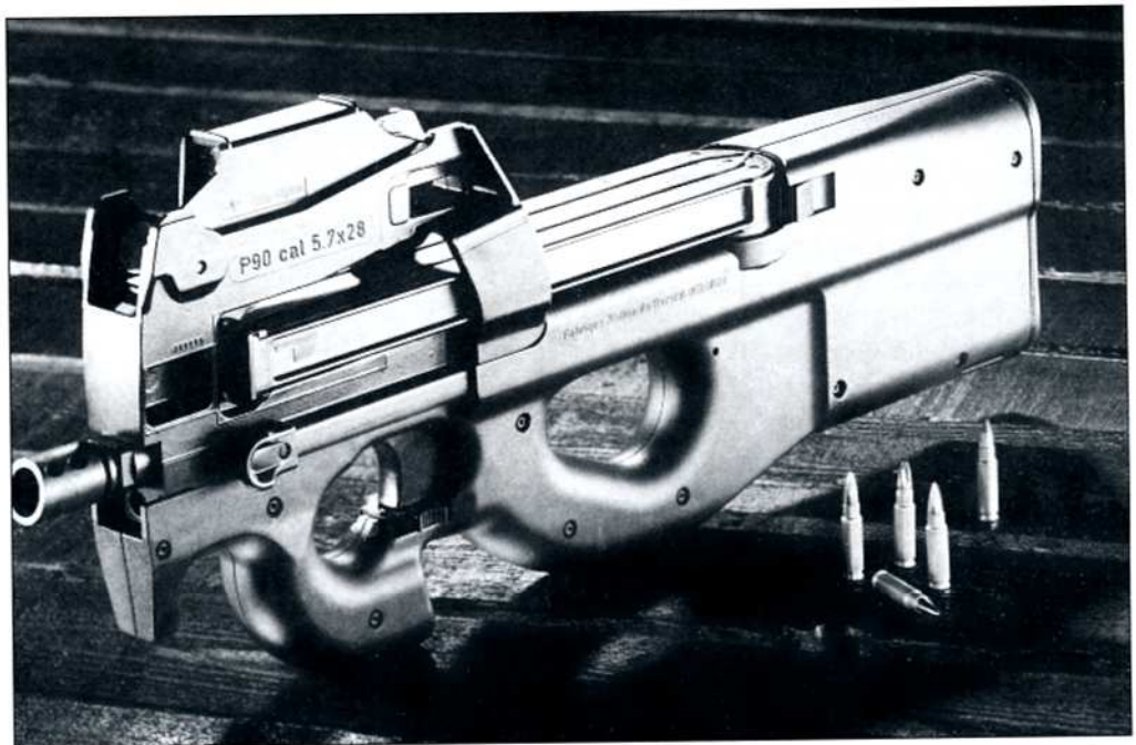
■ 5.7 x 28 FN P90 konepistooli. Aseen vieressä kaliberin patruunalajitelma; tavallinen, valokuovallinen, vaimenninpatruuna ja paukkupatruuna. (Kuva FN Herstal)
