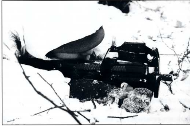
■ Belgialainen sotilas tähtäilee 5.7 x 28 mm P90 konepistoolilla talvisessa maisemassa. Huomaa miten hyvin lipaassa oleva patruunamäärä on todettavissa valmistusmateriaalista johtuen. (Kuva FN Herstal)
