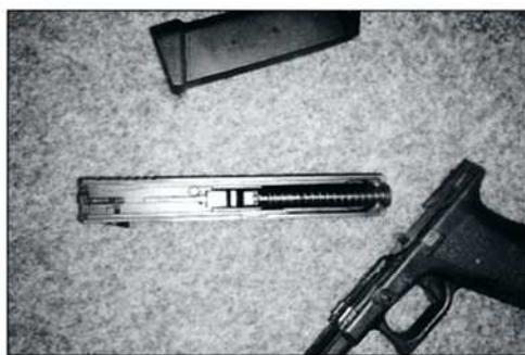
Laser-maalinosoitin asettuu alkuperäisen palautinjousen tilalle, luistin sisäpuolelle.
