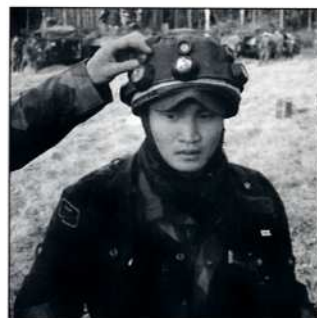
Laser-laitteita käytettiin taisteluharjoituksessa sekä miesten päällä että vaunuissa. Kuvasa kypärään ja taisteluvyöhön asennetut prismat, jotka vastaanottivat lasersäteen.
