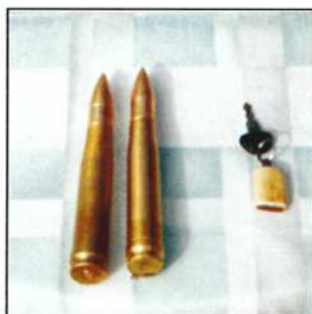
Kaksi 20x138 B mm patruunaa joissa erikoissuunnitellut ja valmistetut tarkkuusammukset.
