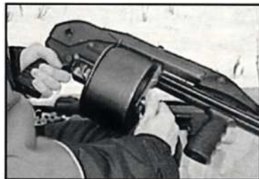
Oikealla kädellä viritetään esijännitys revolverirummun käyttövoimajouselle.
