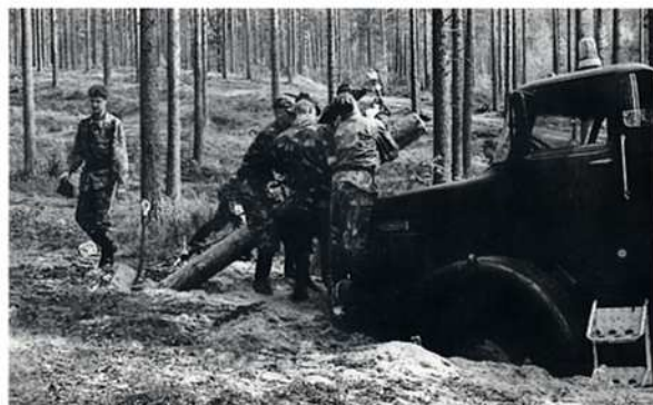
Kun konstit loppuu niin keinot alkaa. Ajoneuvon pelastaminen Apuomien ja vinnin avulla.
