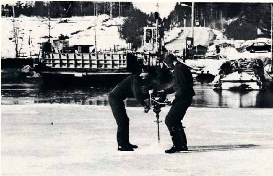
Avantojen kairaus kävi nopeasti moottorikairalla
