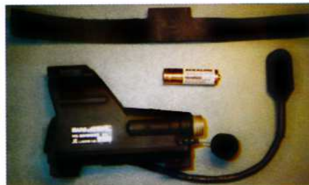
MARS-tähtäin oikealta paristokotelo avattuna. Johdollinen painike erillisellä tarralla kiinnitettävissä aseeseen. Painike ohjaa lasermaalinosoitinta.
