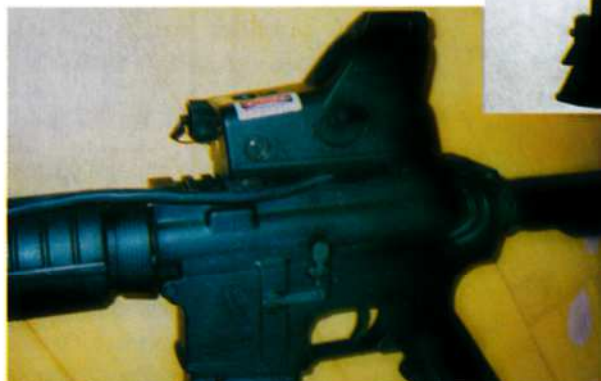
Monitoimitähtäimen runko on alumiinia. Tähtäin kiinnittyy standardin makaiseen varustekiskoon ruuvi kiinnityksellä.
