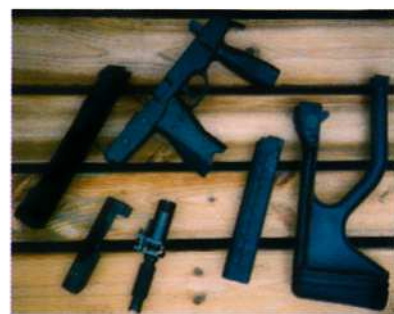
Käyttöhuoltoa varten purettuna. Vasemmalta ylärunko, alarunko, lukko, piippu ohjaimineen, lipas ja olkatuki.
